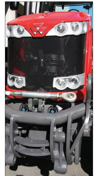
La possibilité d'obtenir un support trois points d'usine confère à l'assemblage plus de robustesse.
